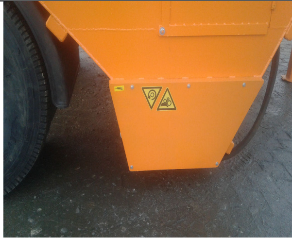
Kuva 1 Ketjukotelon suojakansi jossa pyörimissuunnan osoitin tarra sekä puristumis vaaran varoitustarra
